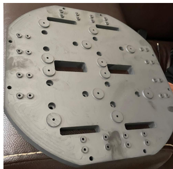
9kx9k探测器 2x2拼接基座
